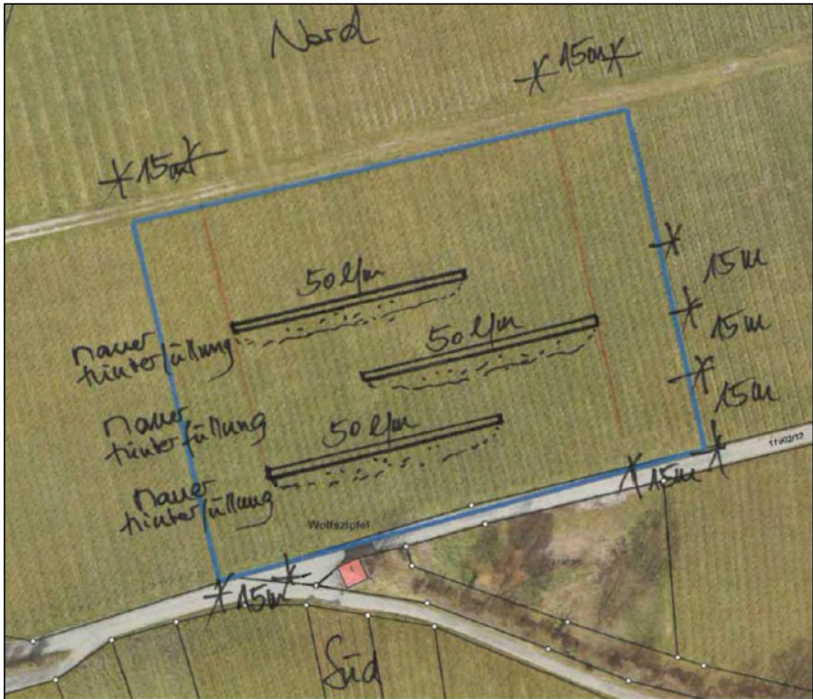
Abbildung 6: Lage der Trockenmauern (Grünflächenamt der Stadt Heilbronn in AG für Tierökologie und Planung GmbH 2025b; Datenquelle Luftbild: LGL, www.lgl-bw.de - Version 2.0)
