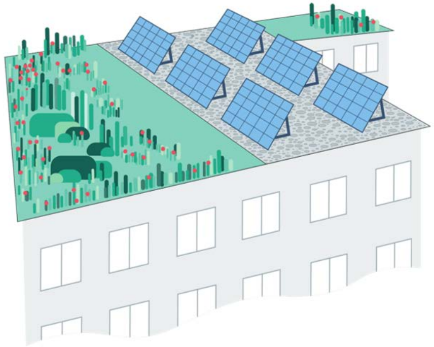
Abbildung 8 Gründach und Solar nebeneinander angeordnet
